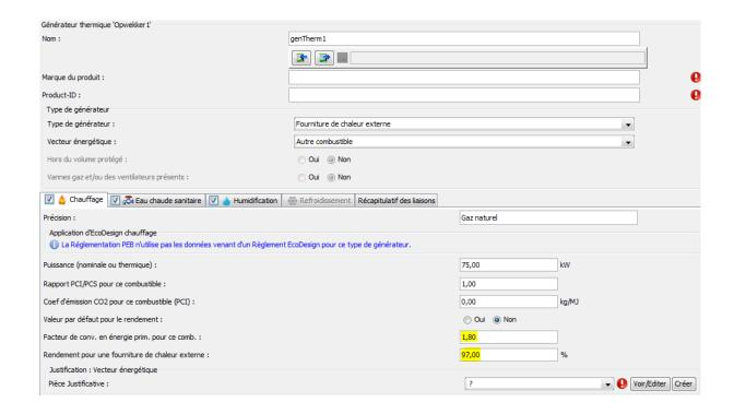
Si le système de fourniture de chaleur externe fournit de la chaleur à une machine à absorption, il faut ajouter le système de fourniture de chaleur externe avec les valeurs indiquées ci-dessus, et le connecter à la machine à absorption encodée avec les valeurs réelles.
